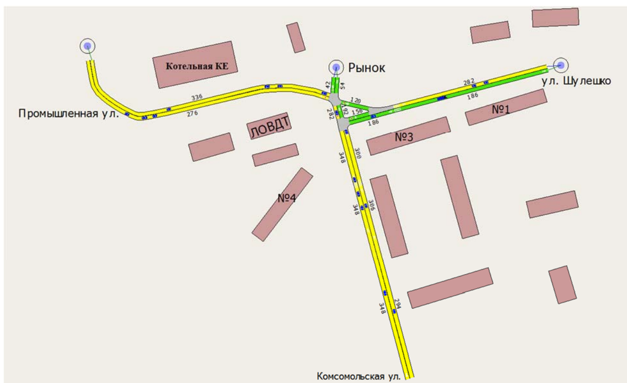
Рисунок 2.11 – Фрагмент моделирования существующей схемы ОДД с картограммой интенсивности транспортных потоков по направлениям движения в границах исследуемого транспортного узла
