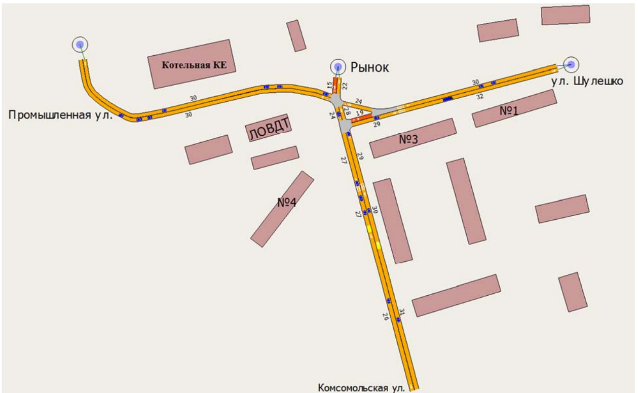
Рисунок 2.12 – Фрагмент моделирования существующей схемы ОДД с картограммой средней скорости транспортных потоков по участкам исследуемого транспортного узла
