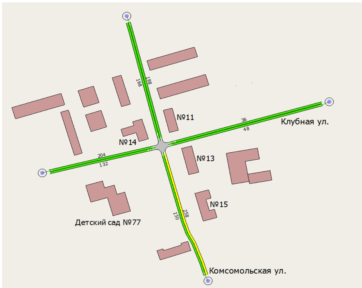
Рисунок 2.9 – Фрагмент моделирования предлагаемой ОДД с картограммой интенсивности транспортных потоков по направления движения в границах исследуемого транспортного узла
