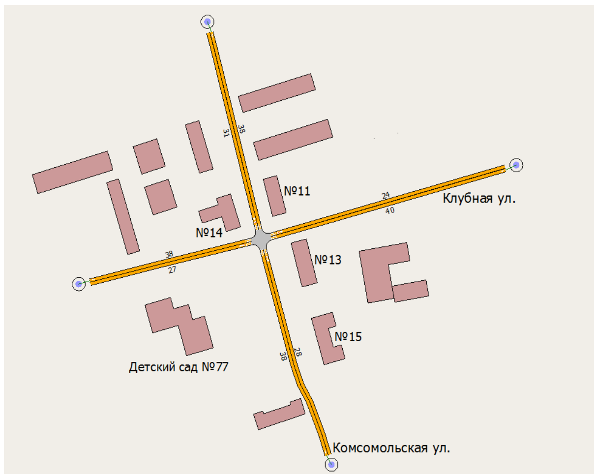
Рисунок 2.10 – Фрагмент моделирования предлагаемой ОДД с картограммой средней скорости транспортных потоков по участкам исследуемого транспортного узла
